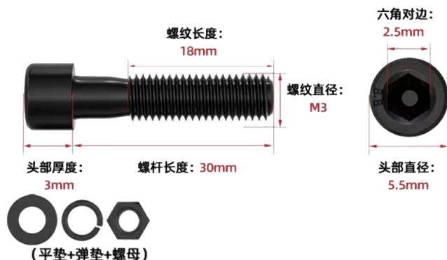
图 8 安装螺栓各部件尺寸
