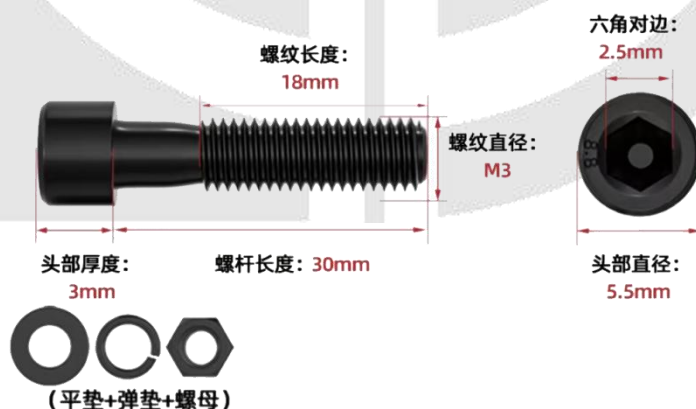
图 8 安装螺栓各部件尺寸
