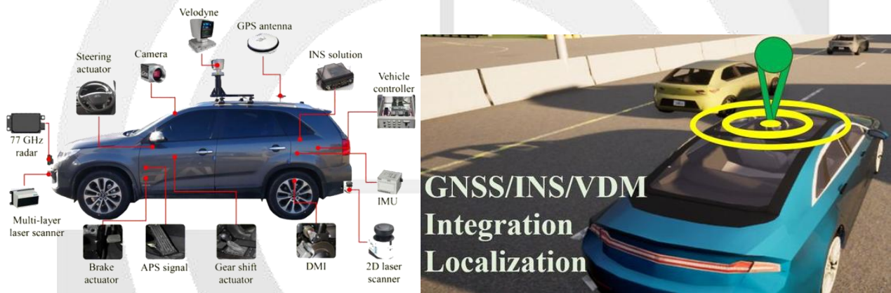
图 3 自动驾驶汽车与组合导航系统
