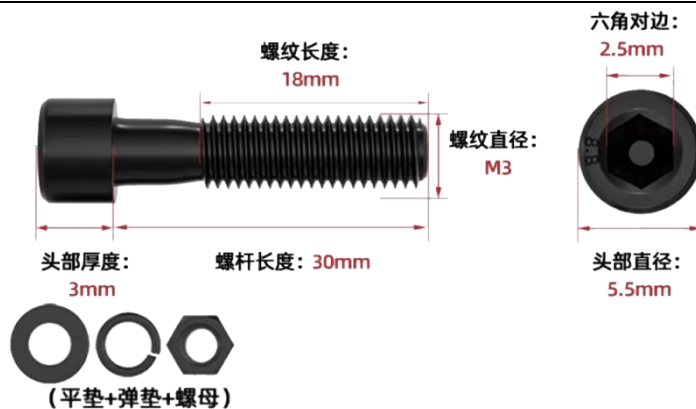
图 7 安装螺栓各部件尺寸
