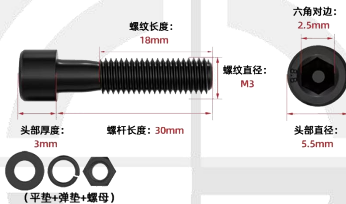
图 7 安装螺栓各部件尺寸
