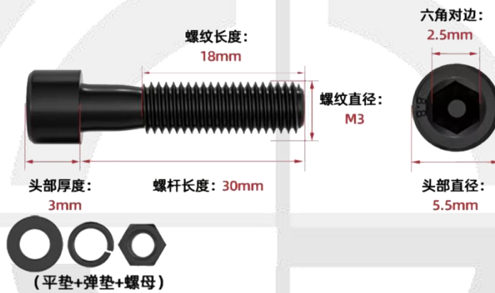
图 7 安装螺栓各部件尺寸
