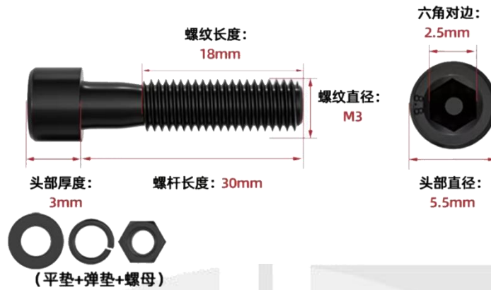
图 7 安装螺栓各部件尺寸
