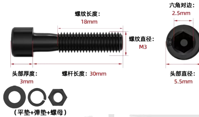
图 7 安装螺栓各部件尺寸
